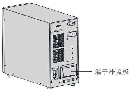
3. 将输入地线连接到端子排左侧后面板上的接地端。
