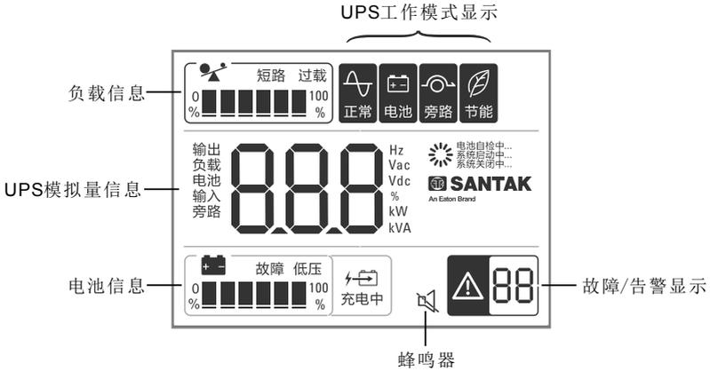
(1) 负载信息：负载量显示，用%表示，档位显示规格如下：
