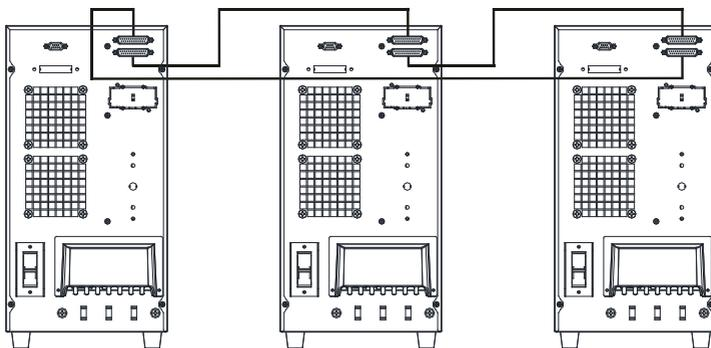
2) 所有并机UPS 输出线接至一输出接线盘，然后由输出接线盘配线去负载。
