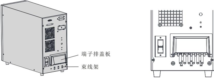
10. 接通市电，将UPS输入保护开关置于“ON”，UPS通电。
