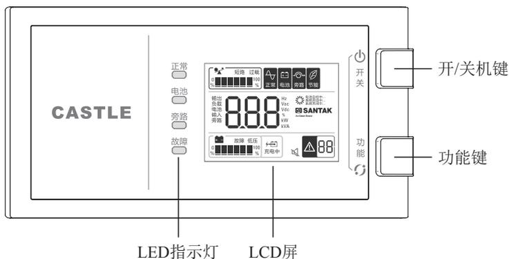
1、开/关机键：控制UPS的开启与关断
